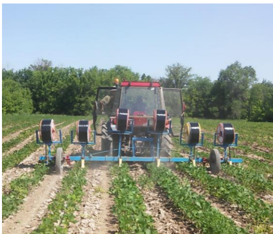
Рисунок 19 – Натягивание капельных лент и орошение системы капельного орошения
